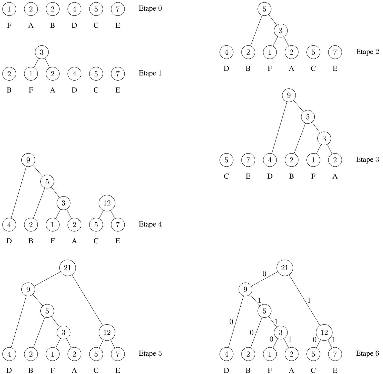
FIGURE 2 – Construction de l'arbre de Huffman
