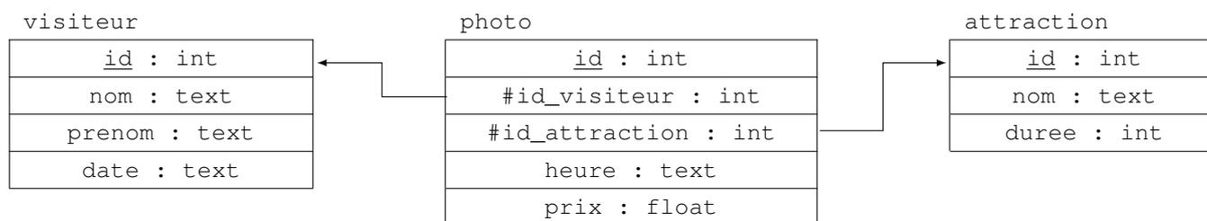
FIGURE 2 – Représentation des relations de la base de données utilisée
