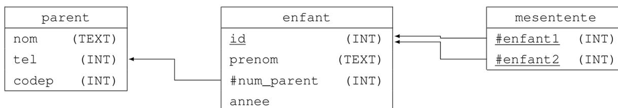
FIGURE 1 – Schéma relationnel de la BDD
