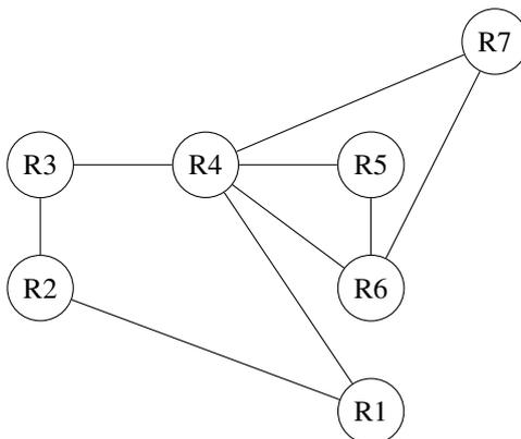
On donne ci-dessous les tables de routage préalablement construites avec le protocole RIP (Routing Information Protocole). Le protocole RIP permet de construire les tables de routage des différents routeurs en indiquant, pour chaque routeur, la distance, en nombre de sauts, qui le sépare d'une autre routeur.
